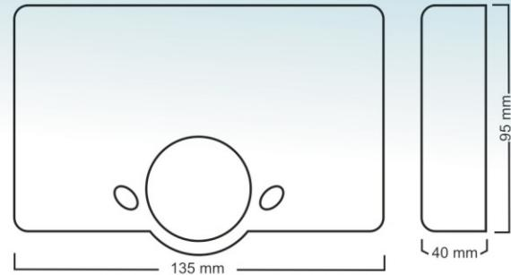
کلید دیمیر سانای مدل ST-DT مخصوص انواع زنت و ایرواشرهاي آپارتمانی با الکتروموتورهای تک دور می باشد.
