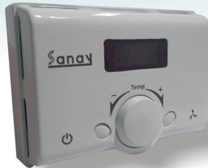
کلید دیمیر ترموستات سانای مدل ST-DT مخصوص انواع زنت و ایرواشرها آپارتمانی با الکترو موتورهای تک دور می باشد این کلید شامل ترموستات دو فصل سرمایش و گرمایش و نیز یک دیمیر جهت تغییر دور فن های فیش باخ در شش مرحله می باشد.
